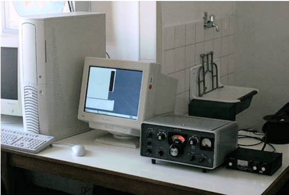
Abbildung: Der „Sender“ des Campus Radio: links der PC mit Bildschirm, daneben rechts der Collins Sender, ganz rechts auf dem Tisch das Antennenanpaßgerät.
